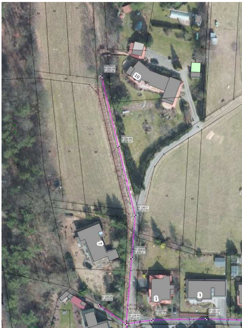
Abb. 8: Auszug Kanalbestandsplan der Gemeinde Cölbe (Quelle: Gem. Cölbe, nachrichtlich 09.03.2021, ohne Maßstab, genordet)
